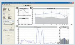
DPOAE20 первоначально производит подробную DP-грамму, которая может сопровождаться тестами ввода/вывода на определенных частотах. Для этих приложений имеются встроенные протоколы испытаний, но вы можете легко создавать и другие протоколы тестов.
