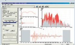
ТЕОАЕ25 для стимуляции отоакустических эмиссий использует линейные или нелинейные широкополосные щелчки. ТЕОАЕ25 предоставляет подробную диагностическую информацию, но в первую очередь предназначен для скрининга слуха. Он может быть запрограммирован на автоматический результат прохождения или непрохождения теста.
