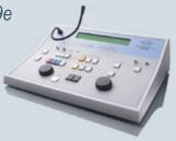
В дополнение ко всем функциям AD229b, AD229e имеет по-настоящему бинауральную речевую аудиометрию, двухканальное моделирование базового слухового аппарата, SISI, Bekesy и тон в шуме.
